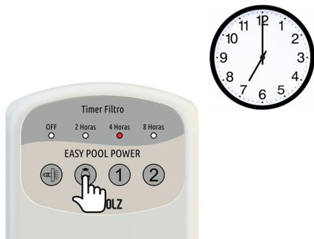
Após quatro horas, a saída será desligada automaticamente e o timer estará configurado para realizar o acionamento diário do filtro conforme indicado na imagem abaixo.
