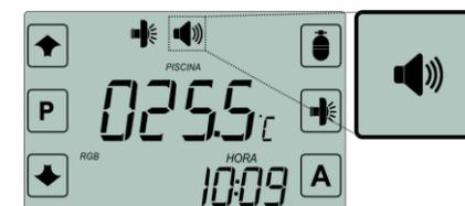
O controlador possui dois modos de controle de iluminação, RGB e Monocromático (ver parâmetro M-3, nível 2 de programação), o modo selecionado ficará visível no display do controlador.
