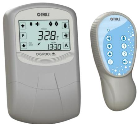
O DIGIPOOL Touch é um equipamento projetado para automatizar o aquecimento solar, filtro e realizar o controle de iluminação RGB ou monocromática de piscinas. Atua no controle da circulação da água através do diferencial de temperatura entre a piscina e os coletores solares, é compatível com trocador de calor e sistemas hidráulicos com uma ou duas bombas. Ele dispõe ainda de uma saída a relé extra.
