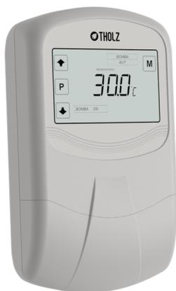
O MMZ é um controlador digital microcontrolado projetado para aplicações de aquecimento solar, atuando no controle da circulação da água através do diferencial de temperatura entre os coletores solares e o reservatório térmico. Permite automatizar o aquecimento de piscinas e boilers, atuando com dois sensores e dispondo de funções de anticongelamento e sobreaquecimento.
